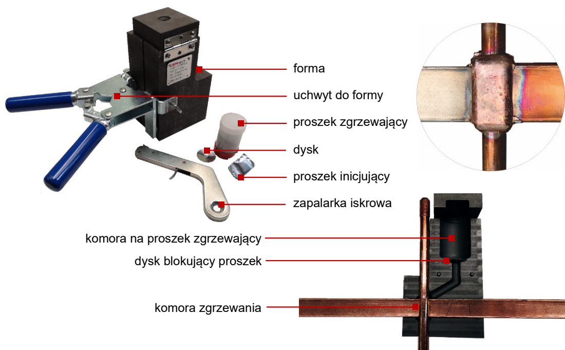
Rys. 7. Podstawowe elementy zgrzewania egzotermicznego na przykładzie formy C-UP-D CBM Weld
