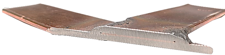
a) połączenie spawane łukowo, spoiny pachwinowe obustronne na całej szerokości bednarki
