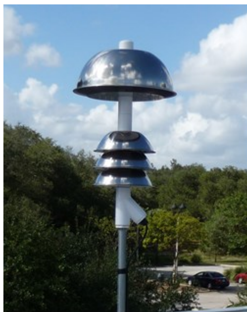
Rys. 1. Przykładowy czujnik pola elektrostatycznego
