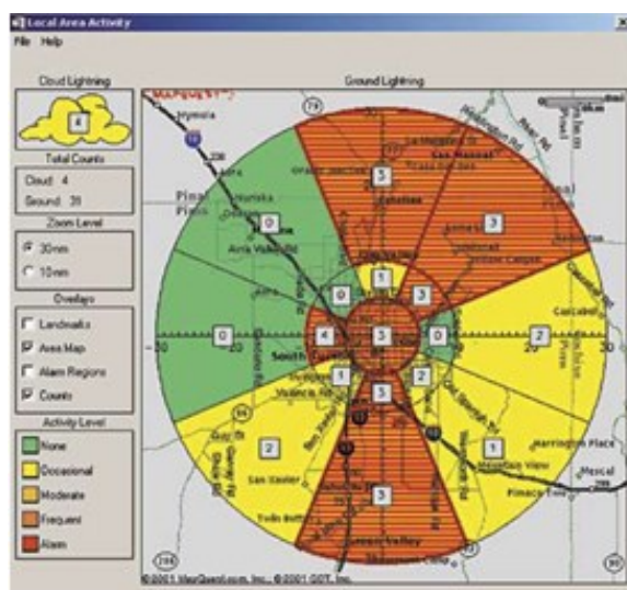
Rys. 5. Okno oprogramowania systemu detekcyjnego z wizualizacją odległości i kierunku wyładowań
