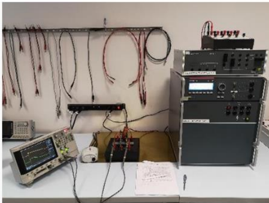
Rys. 4. Stanowisko do prób udarowych w laboratorium RST
