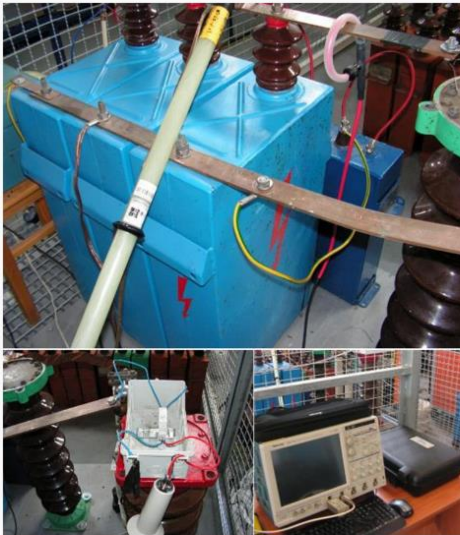
Rys. 6. Stanowisko do prób udarami I_{imp} w Laboratorium Wysokich Napięć WE PB podczas prób kategorii D1 ograniczników marki RST
