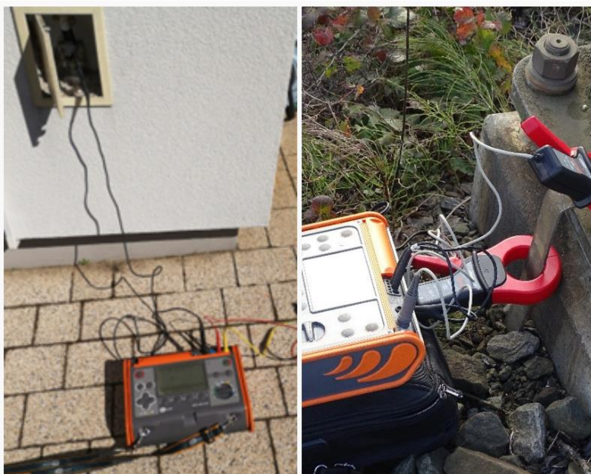
Rys. 2. Pomiar rezystancji uziemienia metodą techniczną 3P (po lewej) i metodą dwucęgową (po prawej)
