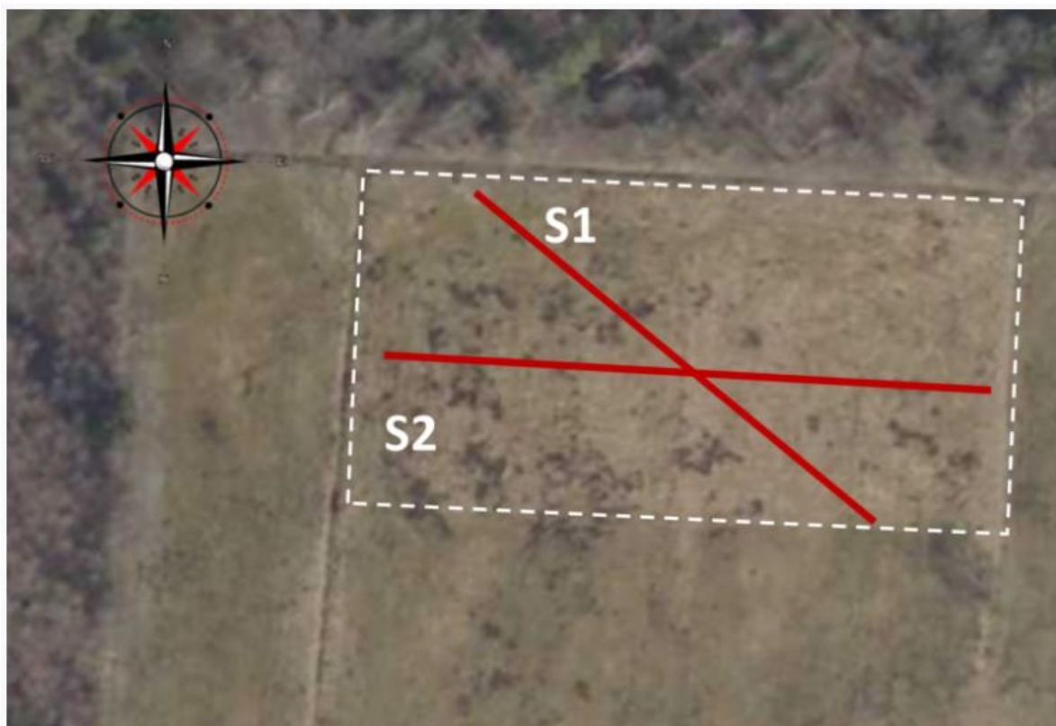
Rys. 3. Badanie rezystywności gruntu z pomiarami przy różnych kierunkach rozstawu sond
