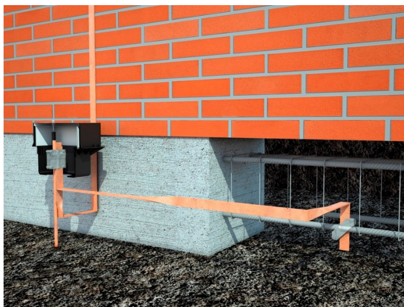
Rys. 5. Wyprowadzenie uziomu fundamentowego do złącza kontrolno-pomiarowego (za zgodą CBM Technology )
