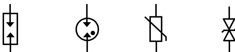
a) iskiernik b) odgromnik gazowy c) warystor d) dioda dwukierunkowa
