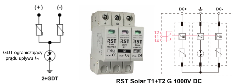
Rysunek 4. Konfiguracje typu Y z odgromnikiem sumującym i schemat połączeń wewnętrznych ogranicznika przepięć do ochrony systemów fotowoltaicznych
